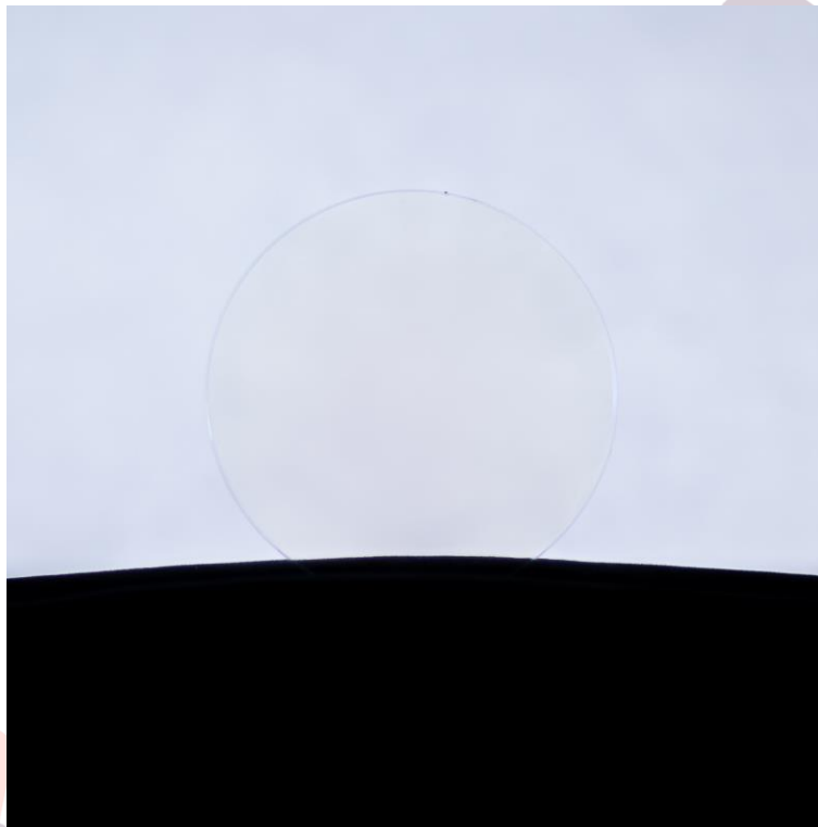
Rys. 19. Fotografia próbki nr 5 - soczewka z filtrem typu BlueBlocker innej firmy.
