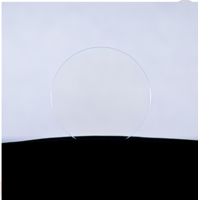
Rys. 11. Fotografia próbki nr 3 - soczewka z filtrem typu BlueBlocker innej firmy.
